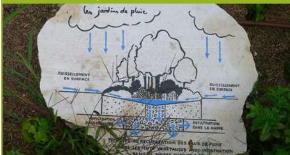
Support pédagogique présentant le fonctionnement des jardins de pluie présent sur le site (source: Municipalité de Saint-Martin-d'Hères)
