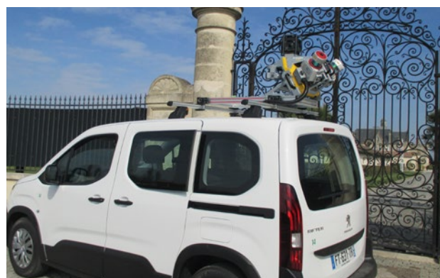
Figure 4 - CereMap3D - Scanner 3D Dynamique d'Environnement du Cerema (source : Cerema)
