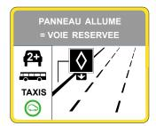
Ce panneau de type SR est positionné en section courante, en accotement droit, en amont de la VR2+. Il est implanté à une distance minimale de 150 m en amont du panneau de présignalisation.
