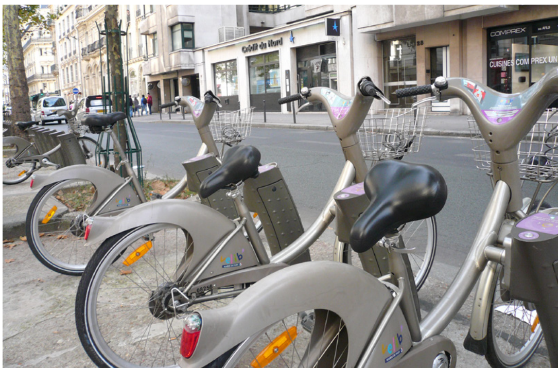
Tourner la selle à l'envers permet à l'opérateur d'identifier très facilement les vélos jugés défectueux par les usagers.
