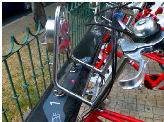
Ecobici à Barcelone : emplacements individuels avec une barre sur laquelle les vélos sont arrimés en soulevant légèrement la roue avant.
