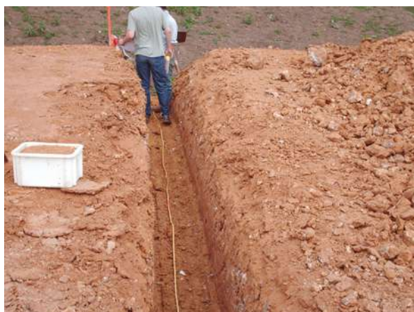
Figure 41 : Sonde TDR posée au sol, avant recouvrement par la couche de remblai supérieure et vue du boîtier de mesure (Source : Cerema - Normandie-Centre)
