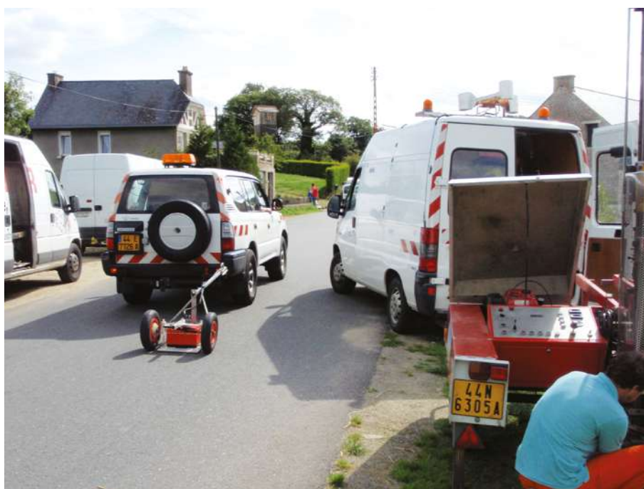
Figure 39 : Passage radar (à gauche) et vérification des anomalies au pénétrodensitographe (à droite) (Source : Cerema Ouest)
