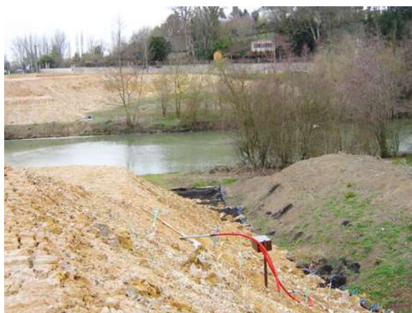
Figure 41 : Sonde TDR posée au sol, avant recouvrement par la couche de remblai supérieure et vue du boîtier de mesure (Source : Cerema - Normandie-Centre)
