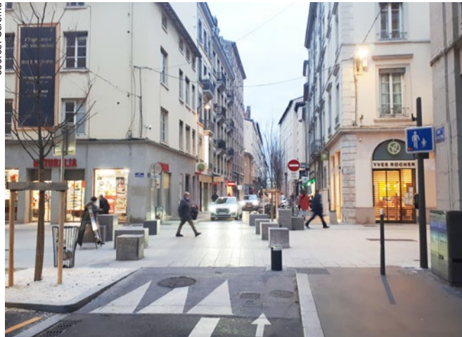
À Lyon, la rue piétonne Victor Hugo a été réaménagée en 2020. Le revêtement du plateau piétonnier est continu à chaque intersection
