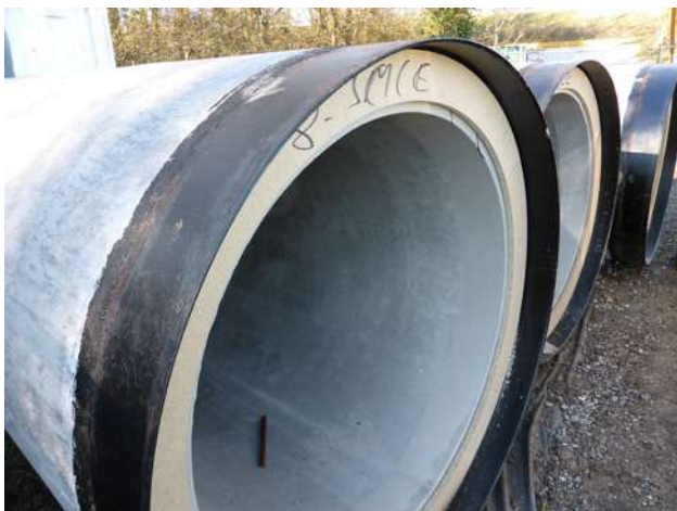
Illustration 15 : Vues sur les anneaux métalliques
