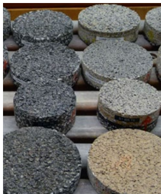
Illustration 7 - Carottes de revêtements du projet Lumiroute (Source: Cerema)
