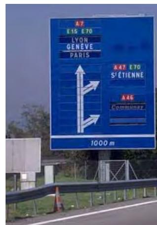
*Placé en entrée de l'agglomération de Lyon, ce panneau directionnel oriente les usagers en direction de Paris soit vers l'A46 soit vers l'A7 en fonction des conditions de circulation.*
