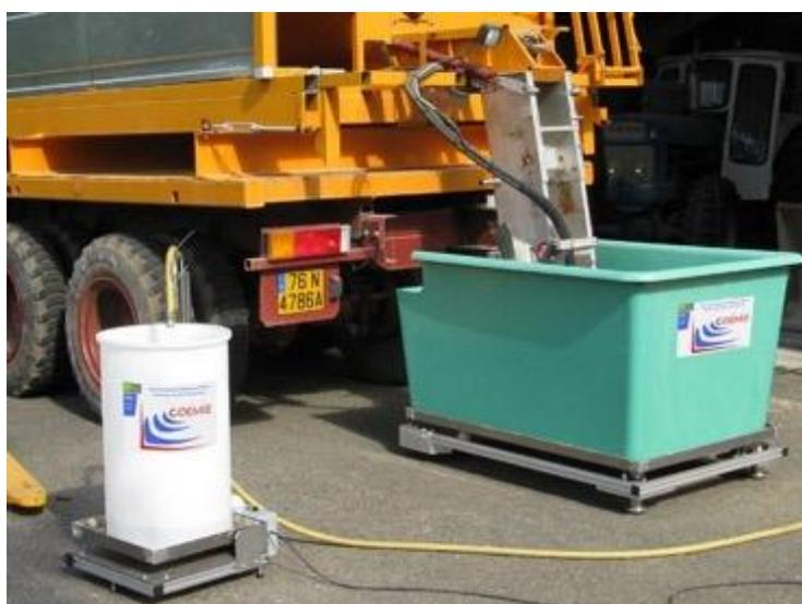
Figure 10.7 : Diverses méthodes de contrôle des épanduses ont été développée ici le système français Odémie
