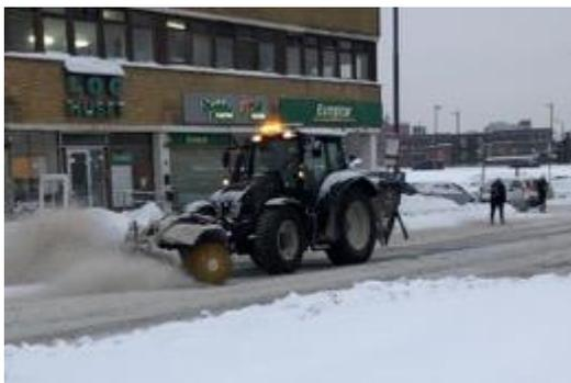
*Figure 10.2 : Tracteur agricole équipé d'une brosse rotative, à Oslo, balayer une technique intéressante qui permet de réduire les quantités de fondants routiers.*
