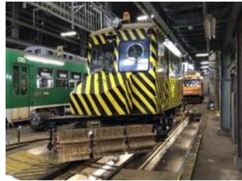
Figure 19.5 : Tramways équipés de brosses rotatives en bambou à Sapporo
