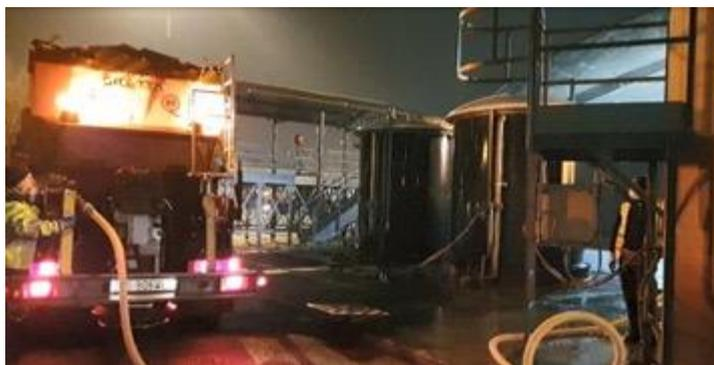
Figure 11.1 : Chargement d'une épandeuse mixte dans une unité de fabrication de saumure à Turin
