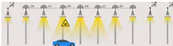
Des synergies entre plusieurs types d'infrastructures permettent d'aller encore plus loin ! Le choix d'un revêtement de la route clair associé à la conversion du parc d'éclairage en LED et la mise en place d'un système de détection au passage des véhicules ou des passants permettent d'obtenir **jusqu'à 90 %** de baisse de la facture d'éclairage public tout en limitant la pollution lumineuse.
