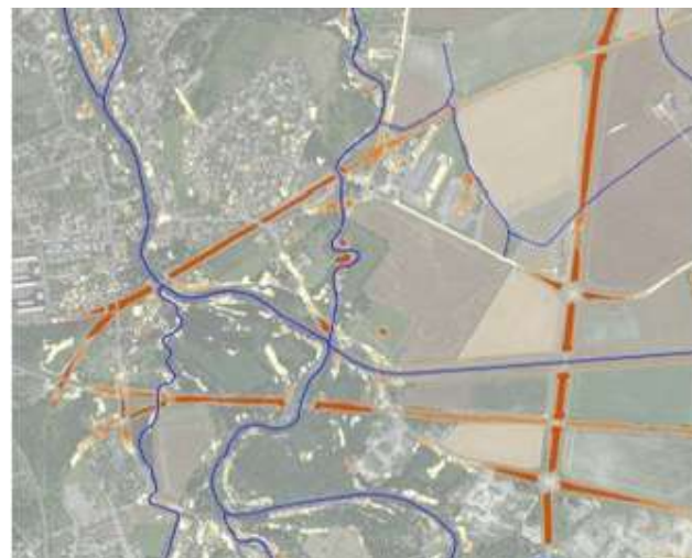
Illustration 85 : exemples de remblais (en orange) détectés avec le LiDAR
