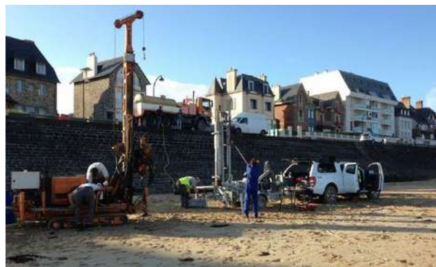
Illustration 29 : utilisation du carottier sur une plage
