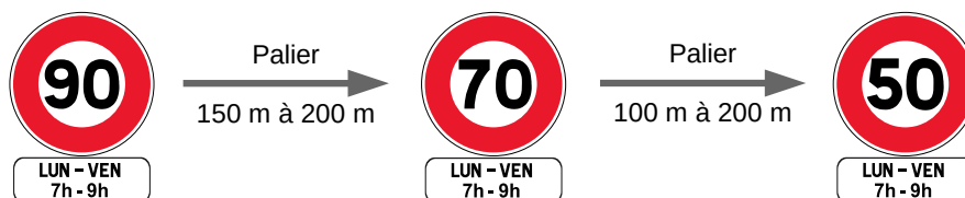
Exemple de signalisation de la baisse de la vitesse horaire par palier, pour une VLA de 110 km/h hors période d'ouverture
