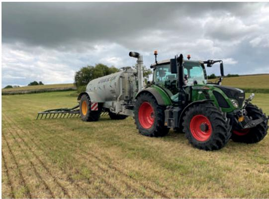
Retour au sol du digestat liquide par rampe à pendillards, pour éviter la volatilisation d'azote ammoniacal dans l'air, source de pertes azotées et de pollution atmosphérique (source : AgroParisTech)
