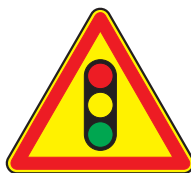
AK17 Annonce de signaux lumineux régulant la circulation
